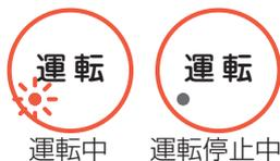
※運転中は加温中ランプが点灯・消灯を繰り返し、一定温度を保つよう制御します。設定温度になると加温中ランプは消灯し、設定温度より下がると再度加温中ランプが点灯します。
