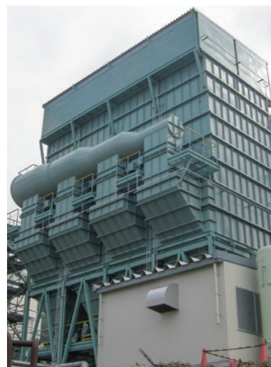
用途：環境集じん(化学工場) 型式：PD-1248N6-22-TR 処理風量：4,200m 3 /min
