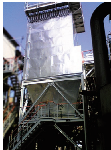
用途：乾燥排ガス集じん(非鉄金属工場) 型式：PD-216N6-18-TR 処理風量：525m 3 /min
