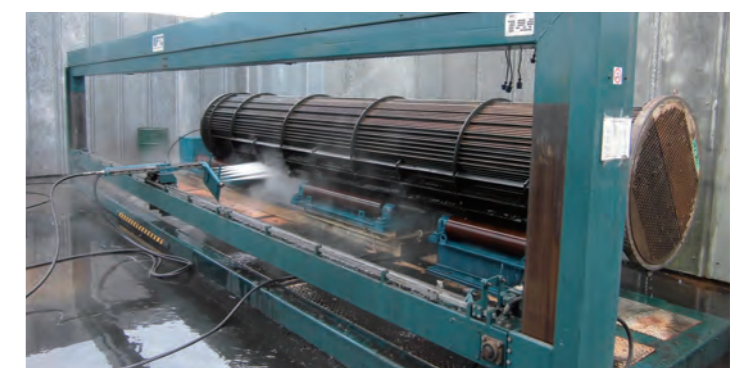
熱交換器チューブバンドル外面洗浄
